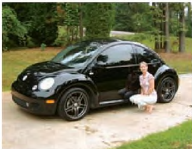
▲ Figura 12.30 Guardafangos de plástico. Los guardafangos de este Beetle de Volkswagen están hechos de Noryl GTX de General Electric, un material compuesto de nylon y de éter polifenílico.
